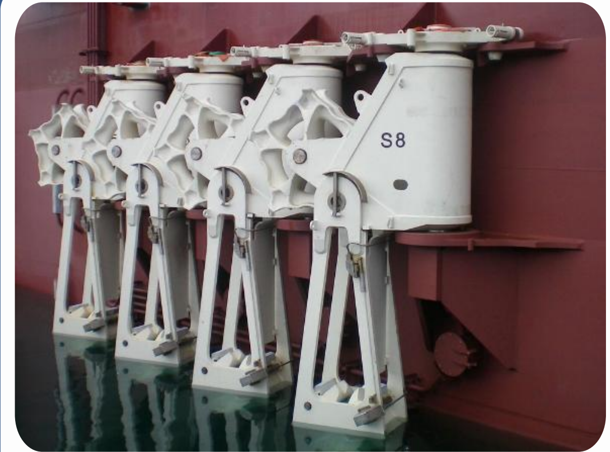
Equipos de amarre y tensado
